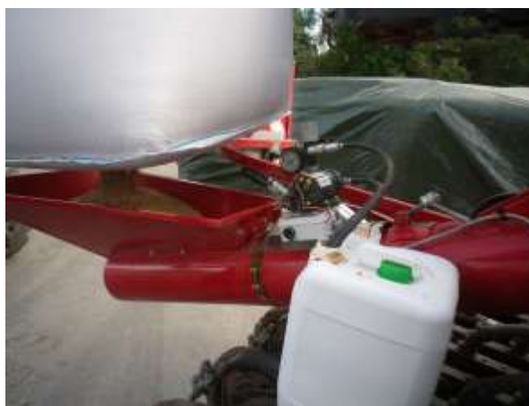
Fotod 1 ja 2. Seemnetöötluks kasutatud tehnika: teraviljaseemne töötlus otse külvikusse tehaseadmega;
