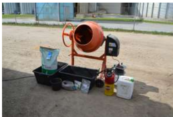
Fotod 3 ja 4. Seemnetöötluks kasutatud tehnika: vasakul isehitatud teraviljaseemne töötlusseade otse külvikusse töötlemiseks; paremal peensemne töötlus tavalise segumasinaga
