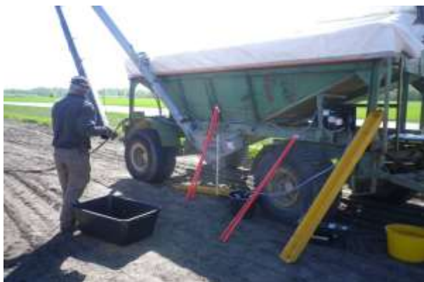
Fotod 3 ja 4. Seemnetöötluks kasutatud tehnika: vasakul isehitatud teraviljaseemne töötlusseade otse külvikusse töötlemiseks; paremal peensemne töötlus tavalise segumasinaga
