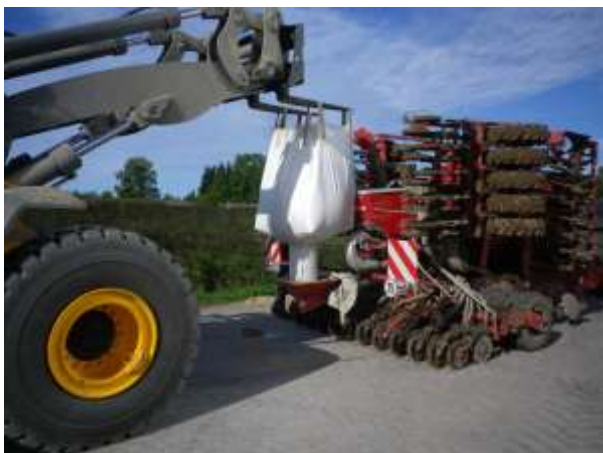
Fotod 1 ja 2. Seemnetöötluks kasutatud tehnika: teraviljaseemne töötlus otse külvikusse tehaseadmega;
